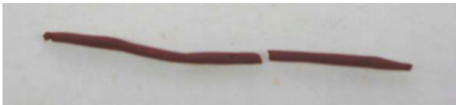
Figura 11. Cilindro de solo rolado, com rompimento indicando consistência ligeiramente plástica.
