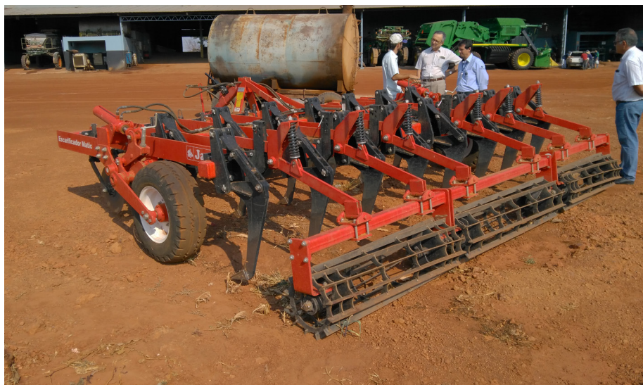
Figura 1. Escarificador com 18 hastes e rolo destorreador disponível no mercado nacional.
