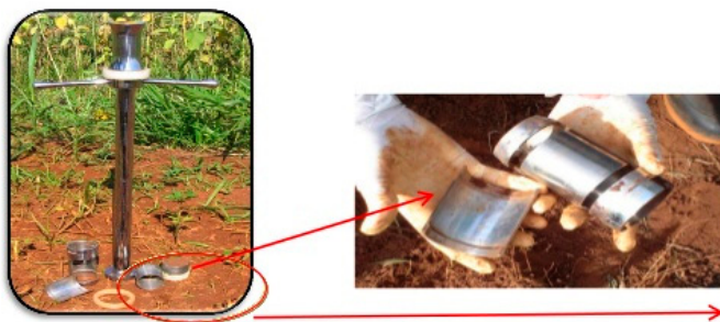
Figura 4. Amostragem do solo para avaliar a densidade com anel volumétrico.
